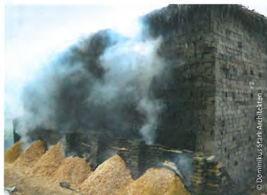
▲ Lokaler Baustoff: Handgeformt und vor Ort gebrannt.
